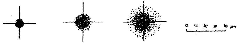
Abb.1 Spotdiagramme für Schmidt-Kamera 120/600mm Bildfeldwinkel: 0^\circ 0^\circ 48' 1^\circ 36'
